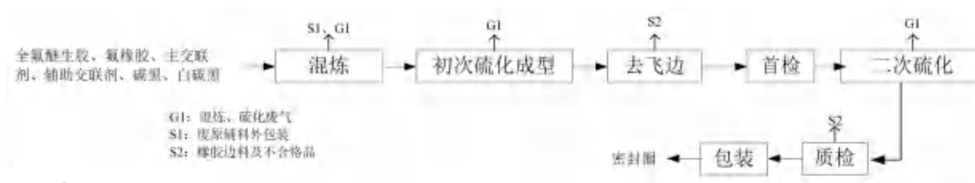
图 3-3 密封圈生产工艺流程图及产污环节
